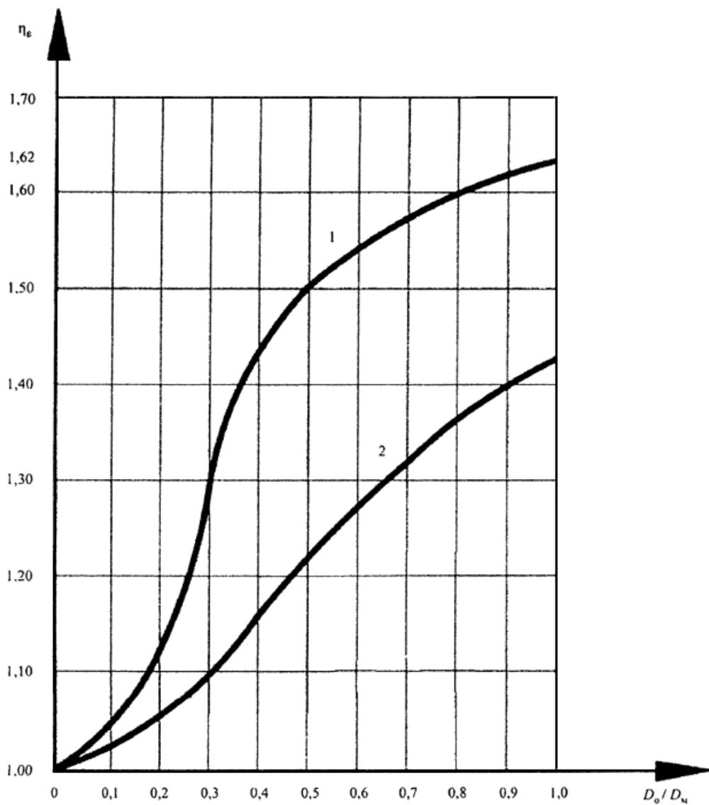
$\eta_B$  - коэффициент несущей способности деталей;  $D_o / D_m$  - отношение наружного диаметра ответвления тройника к наружному диаметру основной трубы тройника
